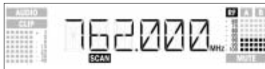
Esempio 1: La frequenza di ricezione 762 MHz ha un livello disturbante di -90 dB.
