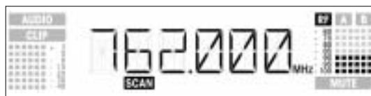
Beispiel 1: Die Empfangsfrequenz 762 MHz hat einen Störpegel von -90 dB.
