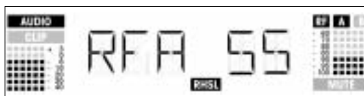
Exemple 2 : L'antenne A était en activité pendant 55% de la période d'essai. Niveau audio maximum : -6 dB ; intensité minimum de champ à l'antenne A : -90 dB.
