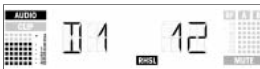
Esempio 1: Dropout dopo 12 secondi, livello audio massimo -6 dB.
