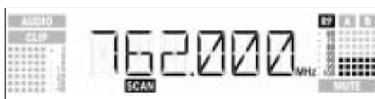
Ejemplo 1: Un nivel de ruido de -90 dB ha sido encontrado en la frecuencia de recepción de 762 MHz.
