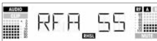
Exemplo 2: a antena A estava ativa durante 55% do tempo de teste. Nível máximo de áudio -6 dB, intensidade mínima de campo da antena A -90 dB.
