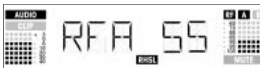
Beispiel 2: Antenne A war 55% der Testzeit aktiv. Maximaler Audiopegel -6 dB, minimale Feldstärke an Antenne A -90 dB.
