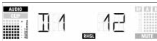
Exemple 1 : dropout après 12 secondes, niveau audio maximum : -6 dB.
