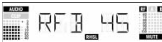
Beispiel 3: Antenne B war 45% der Testzeit aktiv. Maximaler Audiopegel -6 dB, minimale Feldstärke an Antenne B kleiner als -100 dB.
