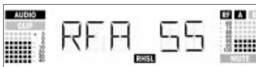
Ejemplo 2: La antena A estuvo activa el 55% del tiempo de verificación. Máximo nivel de audio: -6 dB. Mínima intensidad de campo en la antena A: -90 dB.
