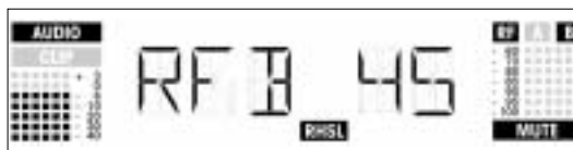
Ejemplo 3: La antena B estuvo activa el 45% del tiempo de verificación. Máximo nivel de audio: -6 dB. Mínima intensidad de campo en la antena B: menor que -100 dB.
