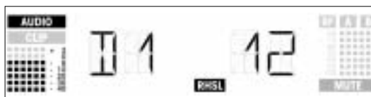
Ejemplo 1: Dropout después de 12 segundos, máximo nivel de audio: -6 dB.
