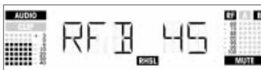
Esempio 3: L'antenna B era attiva per il 45% del periodo testato. Massimo livello audio -6 dB, minima intensità di campo all'antenna B inferiore a -100 dB.
