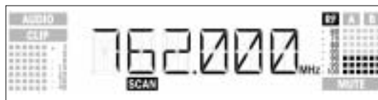
Exemplo 1: a frequência de recepção de 762 MHz tem um nível de ruídos de -90 dB.
